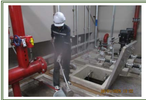
รูปที่ 3-12 การเก็บตัวอย่างคุณภาพน้ำ บริเวณถังเก็บน้ำชั้นใต้ดิน
