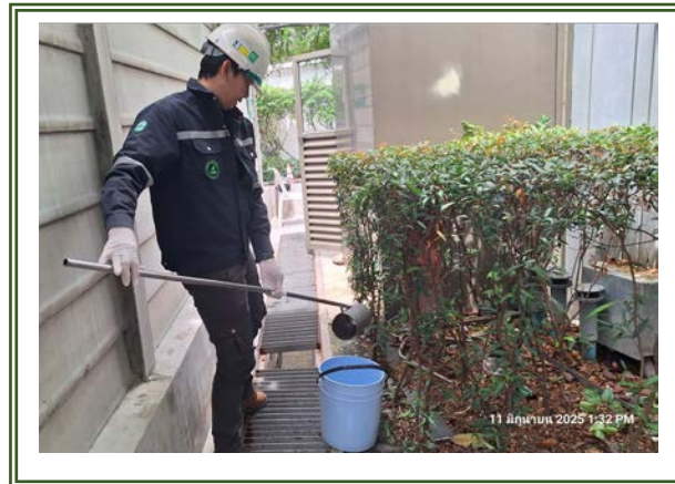
รูปที่ 3-2 การเก็บตัวอย่างคุณภาพน้ำทิ้ง บริเวณน้ำทิ้งหลังผ่านระบบบำบัดน้ำเสีย ในบ่อเก็บน้ำทิ้ง
